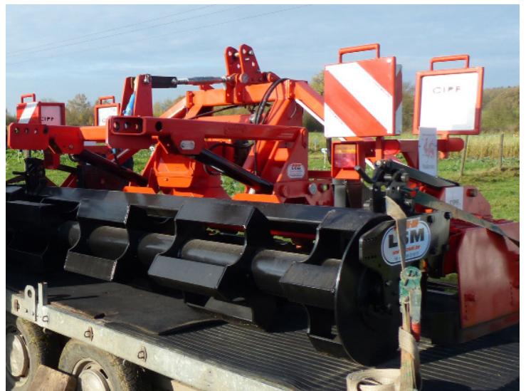
Rouleau anti érosif LSM pour maïs (prototype)
