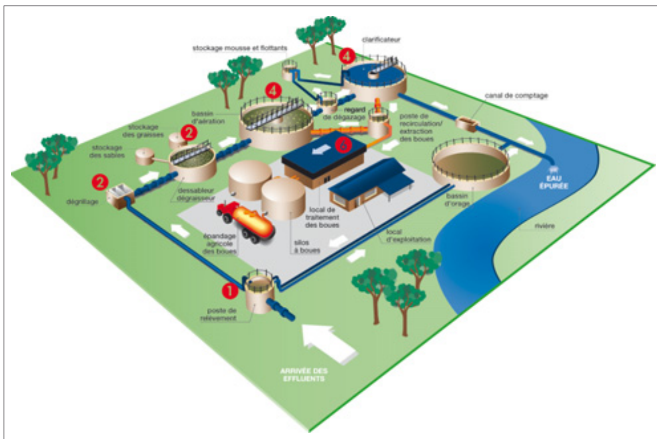
Figure 1 Exemple d'installation avec traitement par boues activées.
