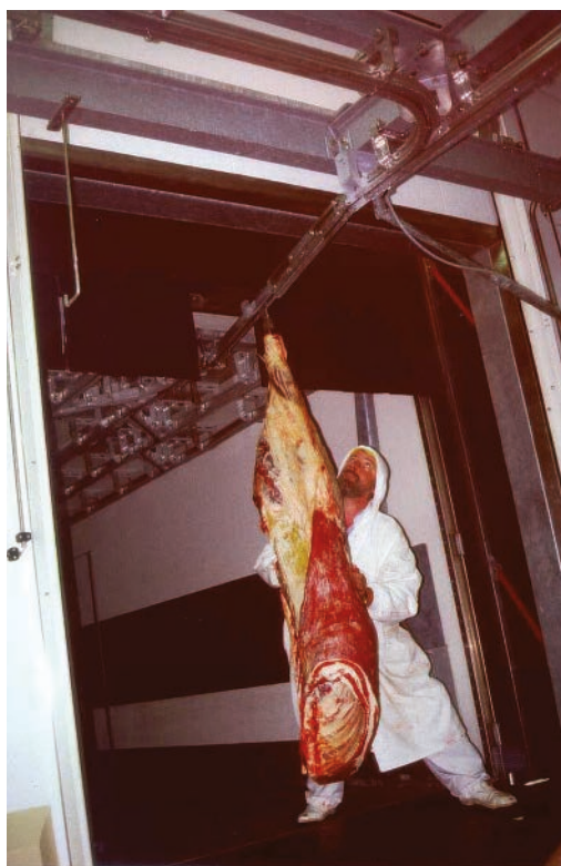
Photo 8.2. Exemple de dispositif de manutention (rail suspendu continu) intégré dans la conception des locaux et adapté au type de camion amené à accoster au quai pour assurer la continuité des manutentions à l'interface de transbordement.
