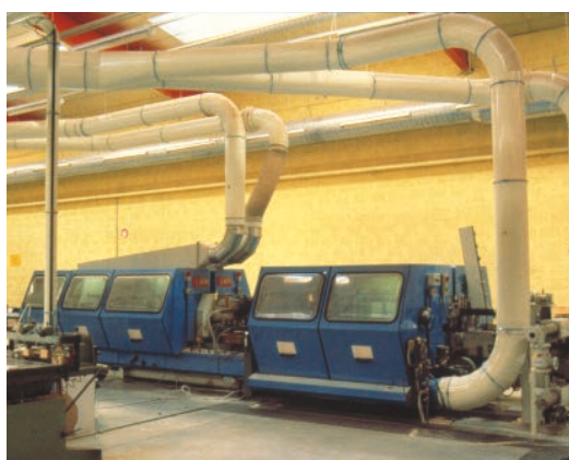
Photo 5.8. Assainissement par dispositifs de captage enveloppant.
